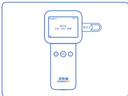
图13 荧光检测卡插卡示意图
