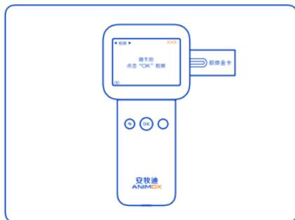
图14 胶体金检测卡插卡示意图
